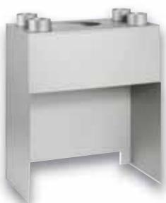
Sur certains de nos appareils, des carénages permettent de capter au plus près l'air chaud autour du foyer. Des gaines de Ø 125 mm placées sur le carénage vont ensuite répartir l'air chaud vers d'autres pièces de l'habitation. Nos carénages sont constitués d'un ensemble de pièces en tôle électro-zinguée, assemblées par vis. Ils sont équipés de 4 sorties d'air chaud de Ø 125 mm.
